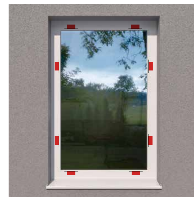
Štandardné usporiadanie uzamykacích bodov I-tec Secure
